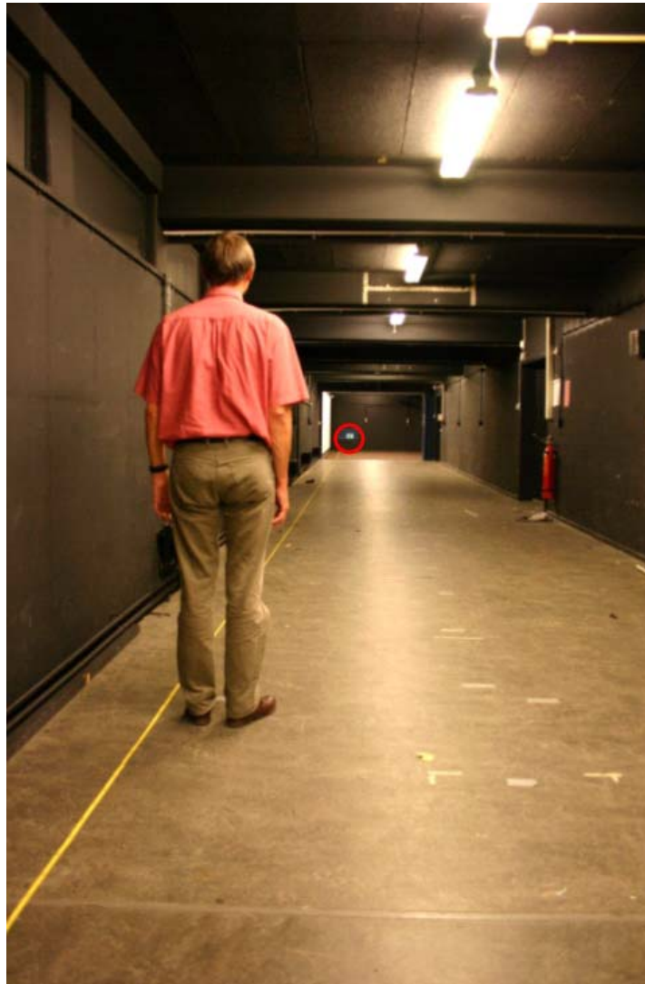
Figuur 2 – De 60 meter lange gang waar het waarnemingsexperiment is uitgevoerd, met aan het einde de TRITIUM LIGHTS vluchtrouteaanduiding. De rode cirkel geeft de positie van de vluchtrouteaanduiding aan.
